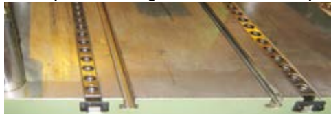
Mesa de prensa com régua hidráulica com esfera
